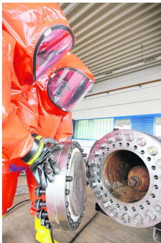
Die UTM-Mitarbeiter Andreas Rudolph und Jan Consael führen den Reaktor vor - hier können gefährliche Gasflaschen geprüft werden. Foto: Roessler
